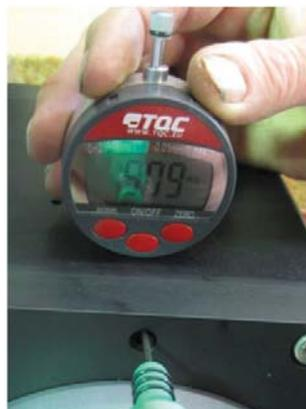
Удерживая микрометр, закрепите его прилагаемым шестигранным ключом 1 мм.
