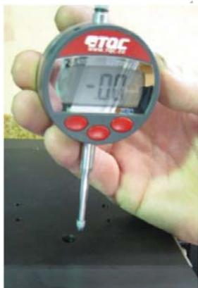
Вставьте щуп микрометра в специальное отверстие в верхней части корпуса прибора.
