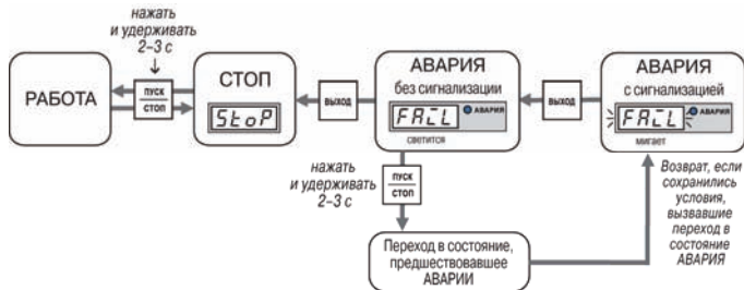
Рисунок 4.2 – Схема переключения состояний прибора
