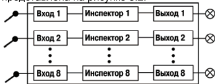
Рисунок 3.2 – Принципиальная схема модификации 2 прибора
