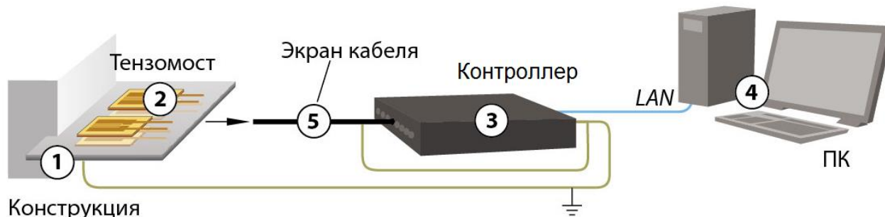
Рис. 2.1 Схема заземления при работе с контроллера с тензорезисторами
