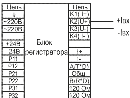
Рис.4 Схема подключения при измерении силы постоянного тока
