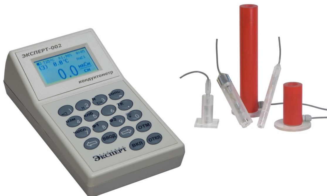
Рисунок 1 – Внешний вид кондуктометра
