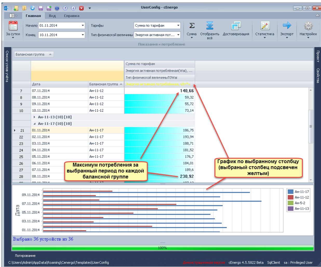
При отображении потребления в суммарном виде можно просмотреть расчет небалансов (включая отклонения от допустимых небалансов при включенной опции «Небалансы» на закладке «Отображение» окна настроек):
