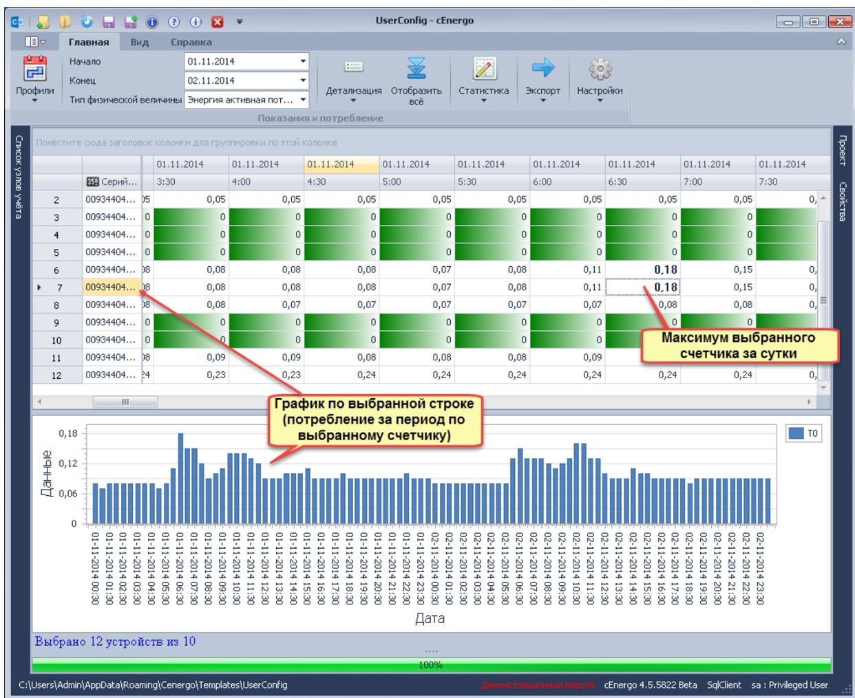
Пример формы просмотра профилей нагрузки (30-минутных) в суммарном виде отображения с включенной опцией расчета небалансов (данная опция доступна только для отображения в суммарном виде). В суммарном режиме просмотра график строится по столбцу, выбранный столбец подсвечивается желтым цветом:
