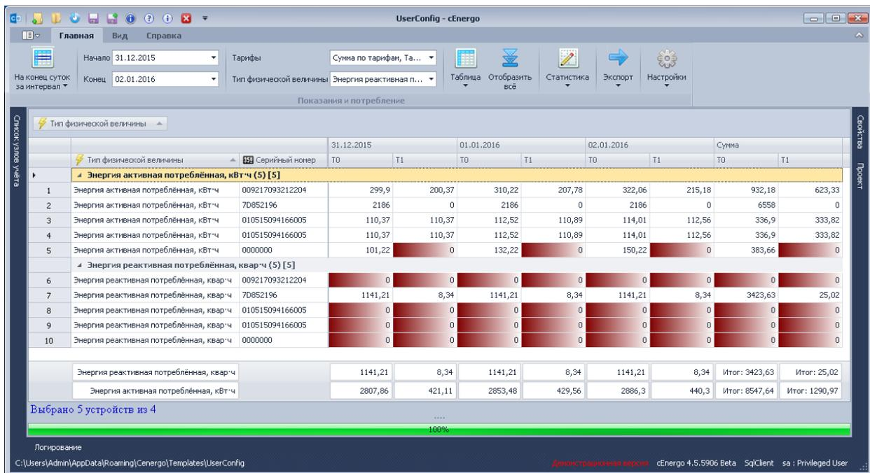
Показания на конец суток/на конец месяца за интервал можно просмотреть и в виде графика, нажав кнопку «График» панели меню модуля. У графика по оси X расположены даты, по оси Y - сумма показаний по всем счетчикам за сутки, рассчитанная на основе показаний на конец суток.
