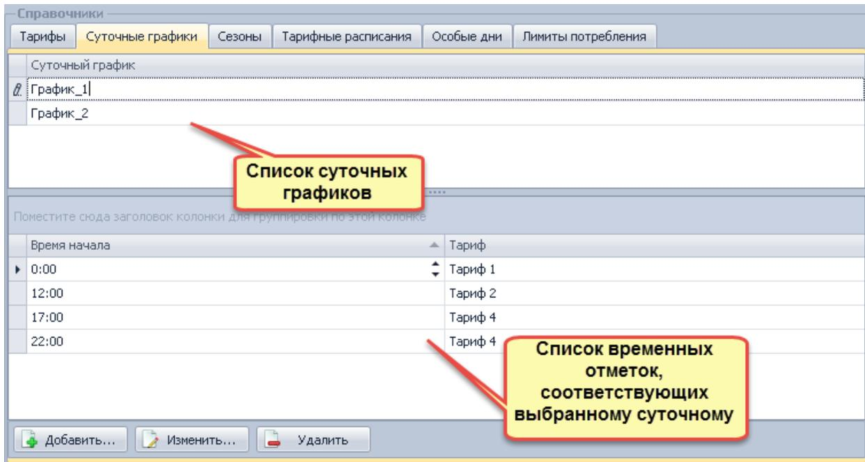
В верхней таблице отображается список суточных графиков, в нижней - перечень временных отметок (и соответствующих им тарифов), входящих в выбранный график. Действие тарифа начинается со времени начала отметки и заканчивается временем начала следующей за ней по расписанию отметки.
