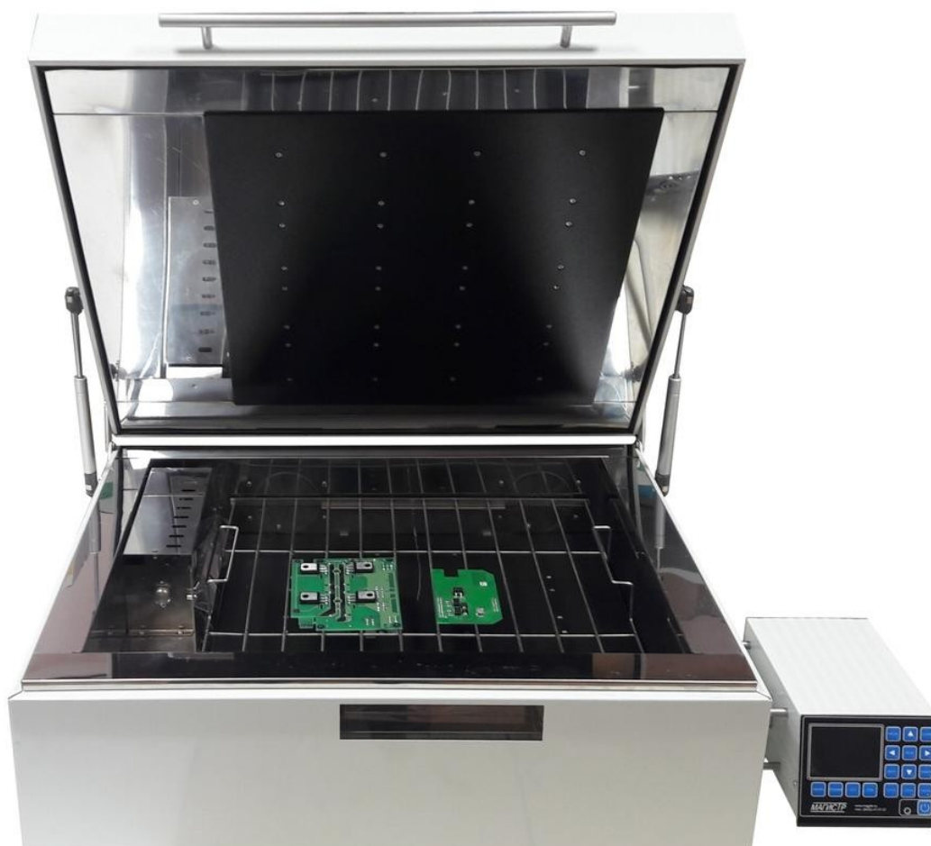
Фото 4. Размещение плат в нагревательной камере
