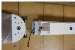
Весовая платформа закрепляется с помощью 4-х болтов
