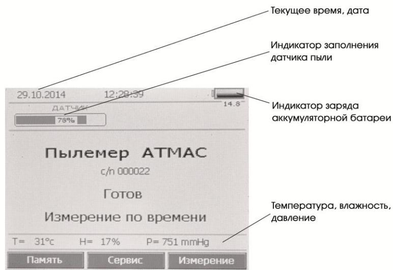
На экране указываются текущие данные – дата, время; климатические параметры (температура, влажность, давление); степень зарядки аккумуляторной батареи; степень заполнения датчика пробой пыли(%).
