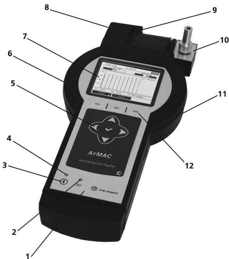
Рисунок 1. Внешний вид анализатора пыли «Атмас»
