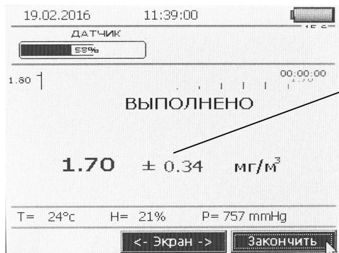
После завершения цикла измерения окончательный результат автоматически сохраняется в памяти прибора.
