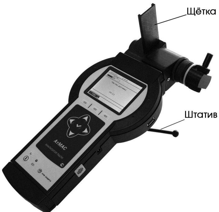
Рисунок 7. Очистка датчика от пыли.
