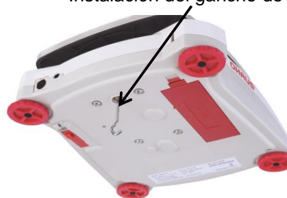
Instalación del gancho de pesaje inferior
