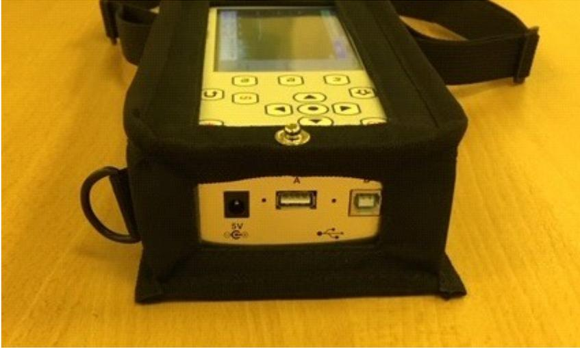
Рис.3. Обеспечение доступа к разъемам и питания.
