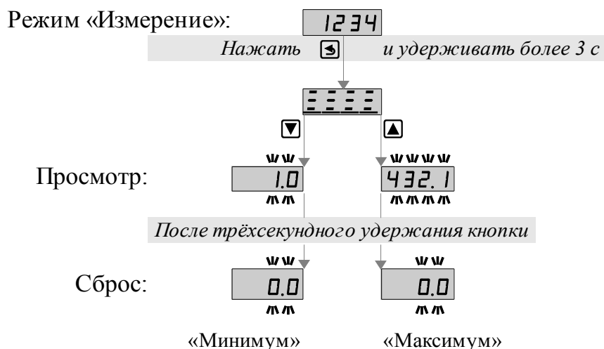
Рисунок 7 - Вход в режим «Экстремумы», просмотр и сброс зарегистрированных максимума и минимума давления
