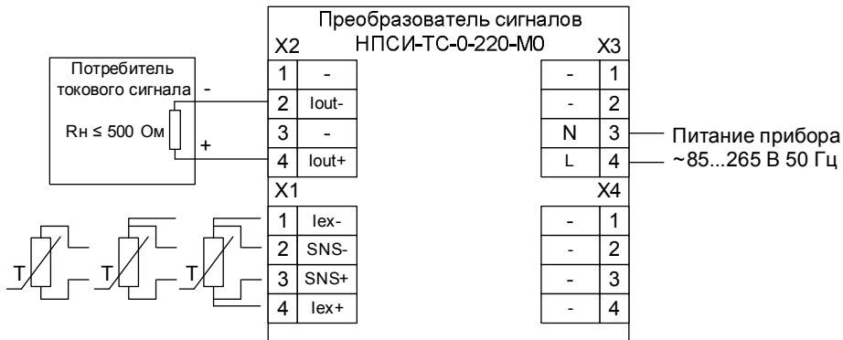
Рисунок 6 – Электрическая схема подключения преобразователей НПСИ-ТС-0-220-МХ, М(Х/М), М(Х/ВС/М)
