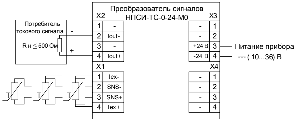
Рисунок 7 – Электрическая схема подключения преобразователей НПСИ-ТС-0-24-МХ, М(Х/М), М(Х/ВС/М)
