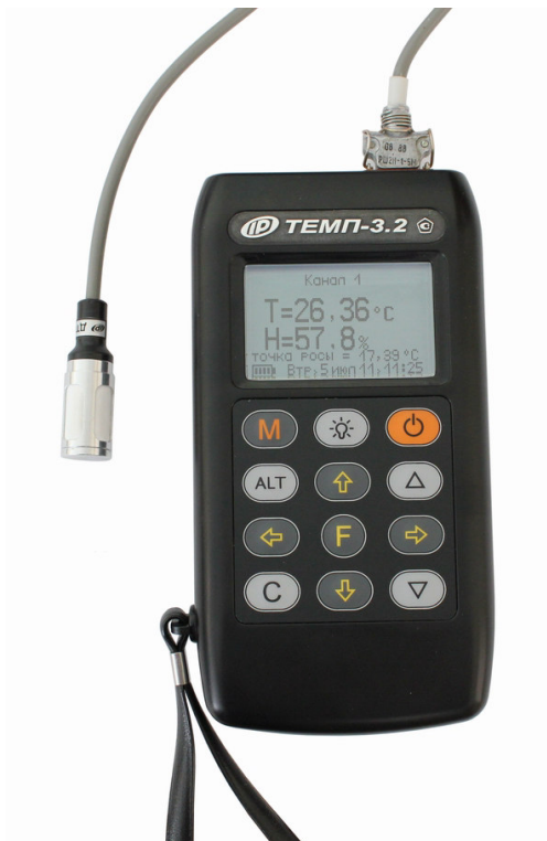
Рисунок 1- Общий вид прибора модификации «ТЕМП-3.20» с совмещенным датчиком температуры и влажности ДТГ
