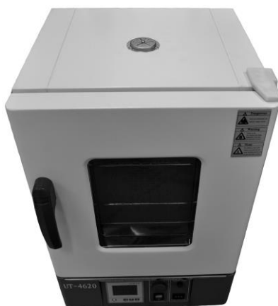
Рис. 2. Шкаф сушильный. Вид сверху.
