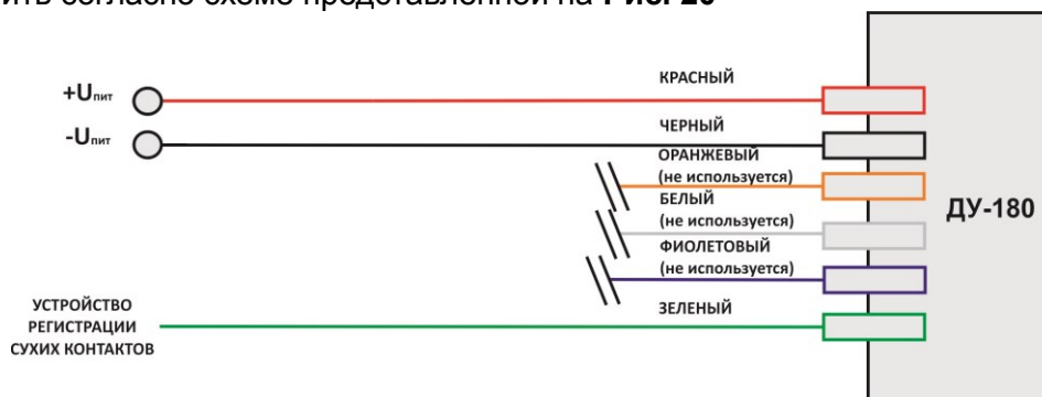
Рис. 20. Схема подключения в режиме «Отвал» и «Ковш»
