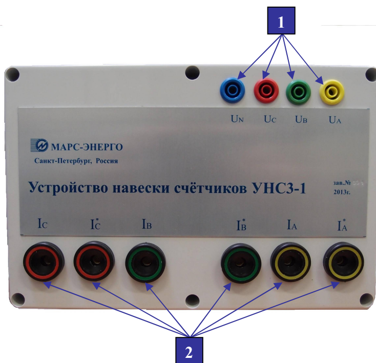
Рис. 3. Блок подключения к установке 1 – разъемы по напряжению, 2 – разъемы по току
