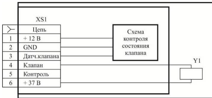
Рисунок 9 – Клапан КЗГЭМ-У. Схема электрическая принципиальная.
