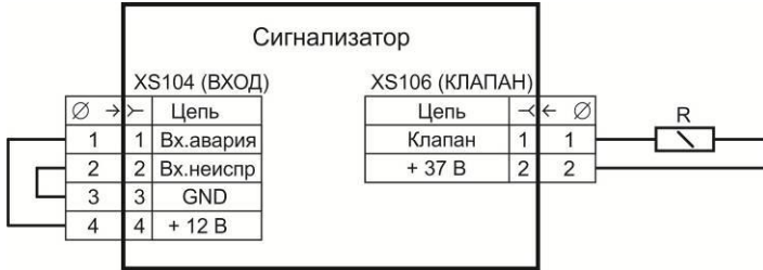
Рисунок Г.1 – Установка переключателя и имитатора клапана
