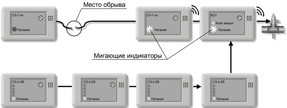
Рисунок 3 – Реакция Системы на обрыв кабеля
