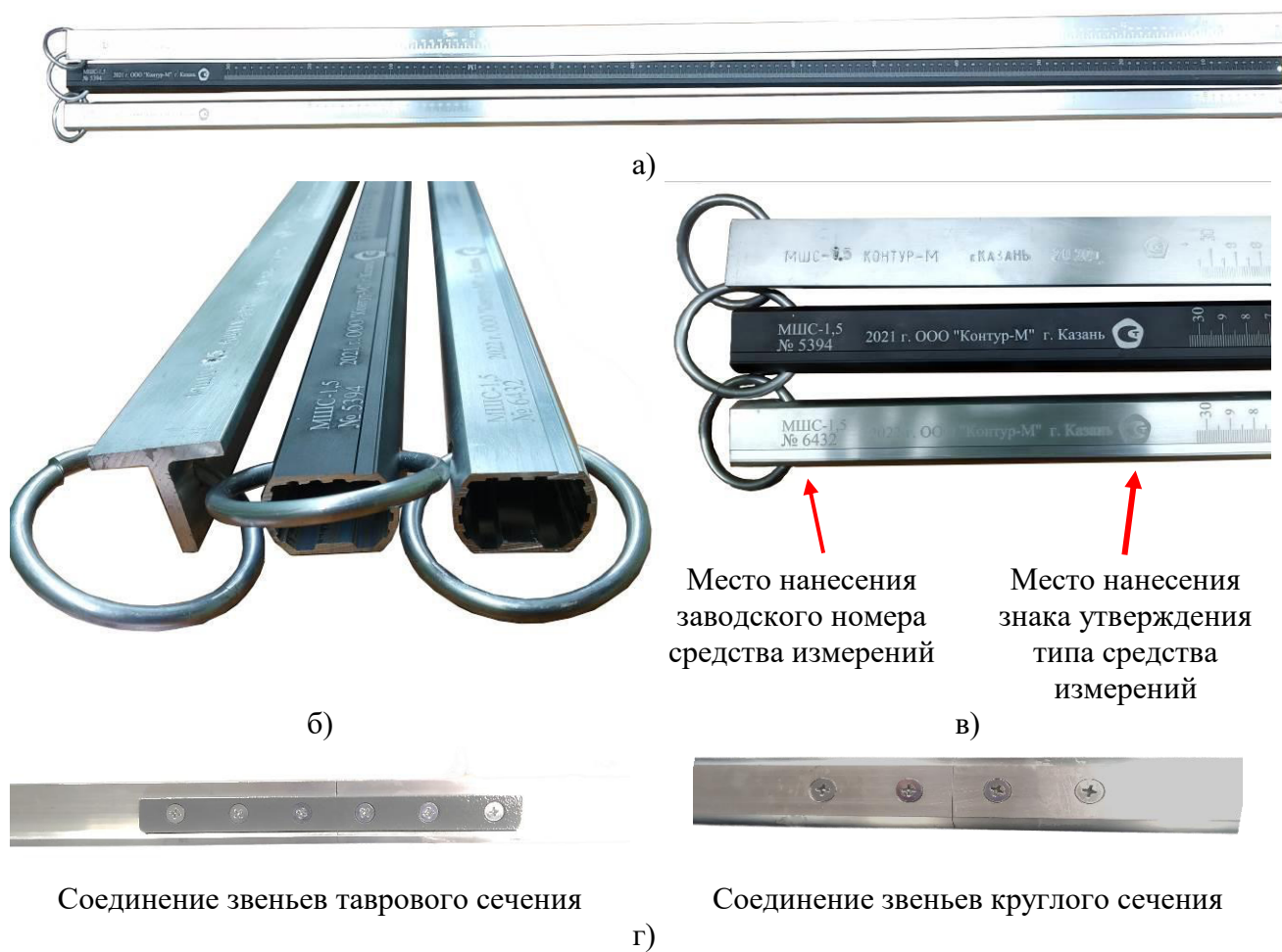
Рисунок 1 – Общий метроштоков: а) общий вид; б) вид с торца; в) места расположения заводского номера и знака утверждения типа средства измерений; г) соединение звеньев метроштоков
