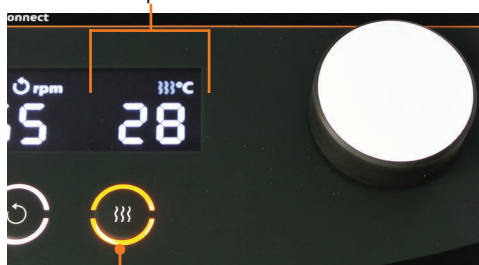
Heiz-Taste: Heizung an
