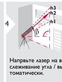
Направьте лазер на верхние точки и отслеживание угла / высоты начнется автоматически.
