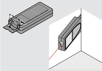
**i** Направление позиционной скобы определяется автоматически и соответственно регулируется начало отсчета.
