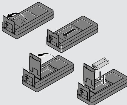
Для обеспечения надежного функционирования не используйте угольно-цинковые аккумуляторные батареи. Замените батареи, когда на дисплее появится мигающий символ батареи.
