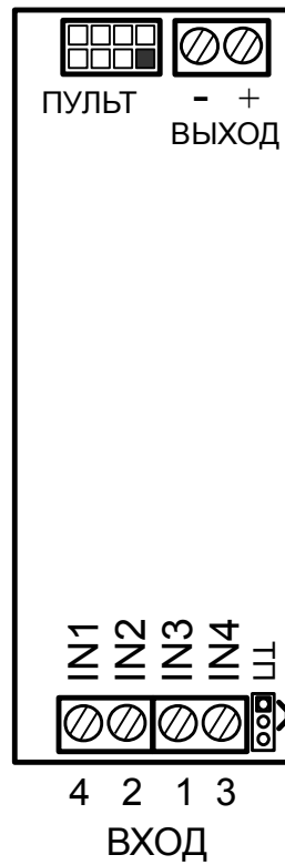
Рисунок В.8 - Расположение входных клемм и разъёма для подключения пульта программирования на плате измерительного преобразователя в ИТ-2Ц.Р (без корпуса и крышки)
