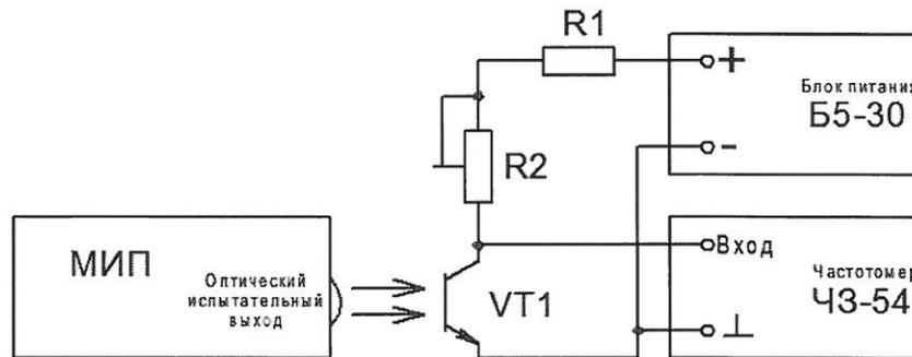
Схема соединений для проверки точности хода часов
