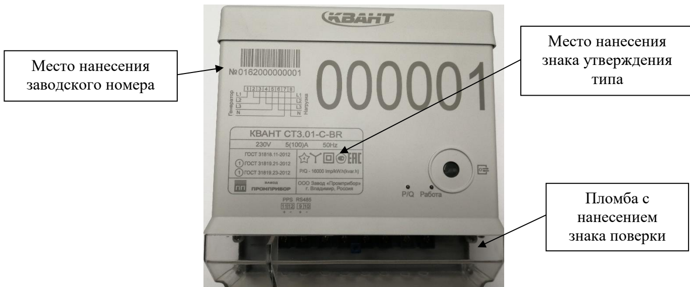
Рисунок 2 – Общий вид счетчиков в корпусе типа С с указанием места ограничения доступа к местам настройки (регулировки), места нанесения знака утверждения типа, места нанесения заводского номера
