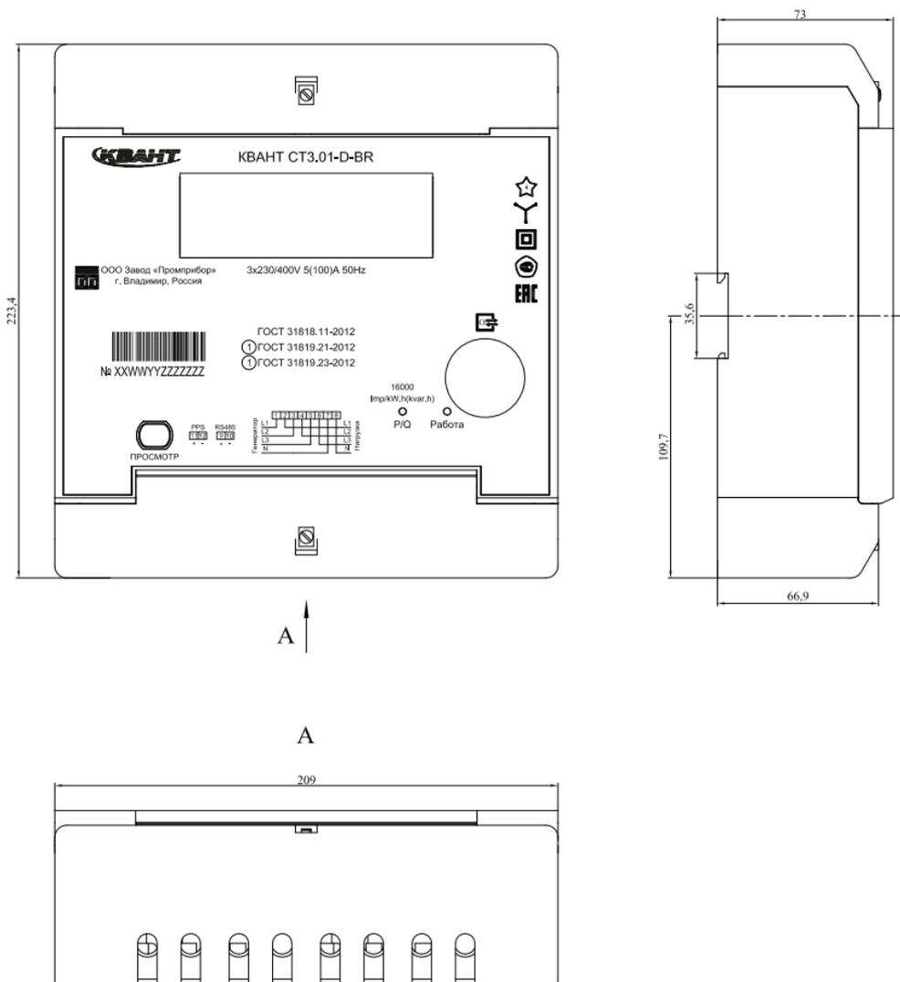
Рисунок А.1 - Размеры счетчика в исполнении D
