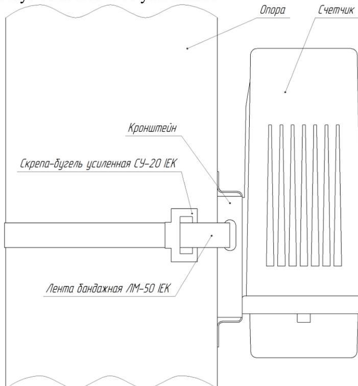
Рисунок 3.2 – Счетчик с кронштейном на опоре
