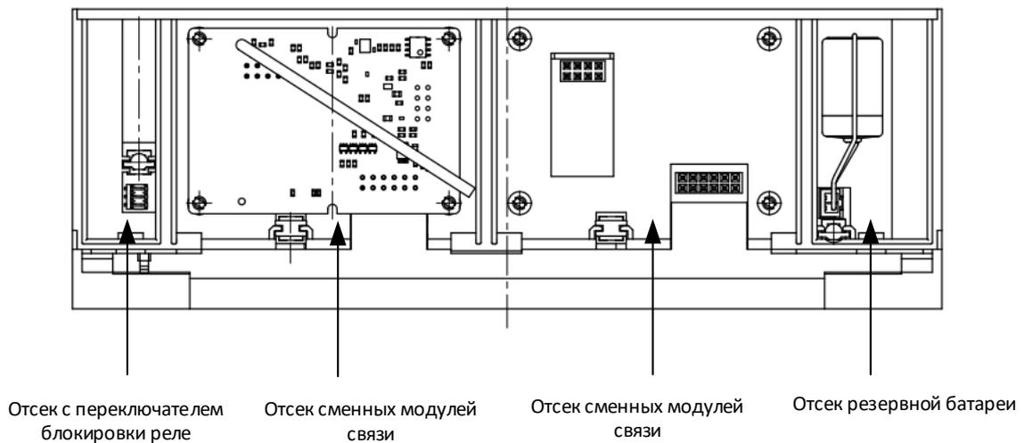
Рисунок А.3 - Счетчик в исполнении D со снятой верхней крышкой и снятыми крышками отсеков.
