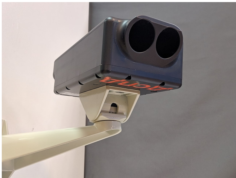
Рис. 1. Общий вид датчика состояния поверхности дорожного полотна «ДСПД».
