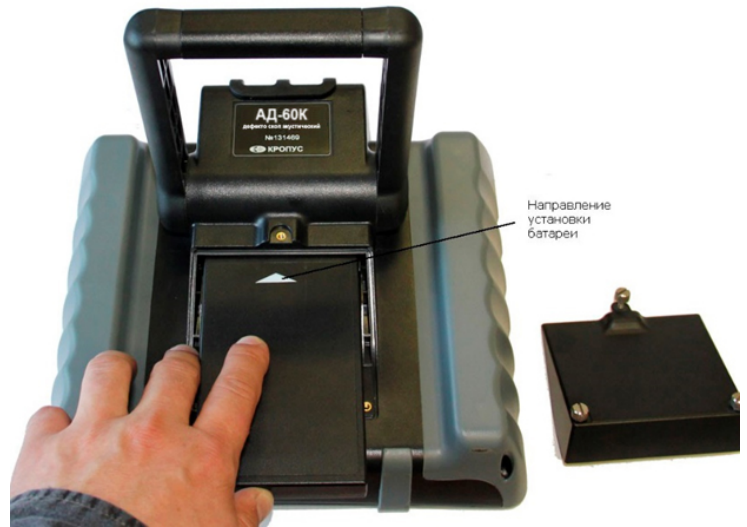
Рис 1-4 Установка нового аккумулятора
