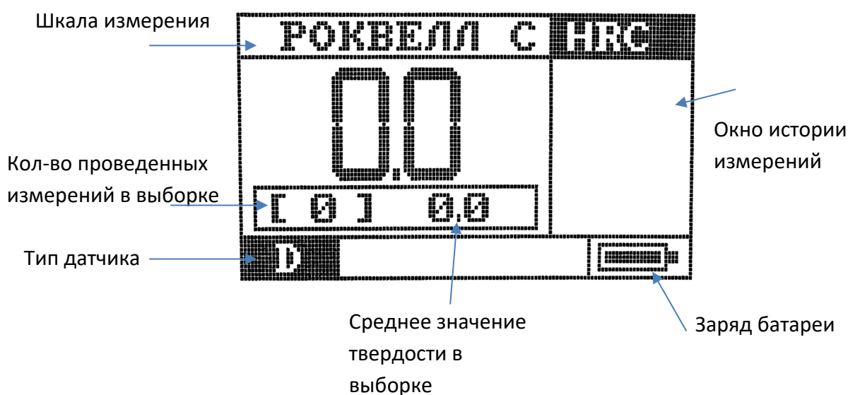
РИС. 7 ВИД ЭКРАНА ПРИБОРА ПОСЛЕ ВКЛЮЧЕНИЯ
