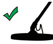
Правильный угол поисковой катушки к земле
