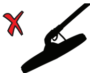
Неверный угол поисковой катушки к земле
