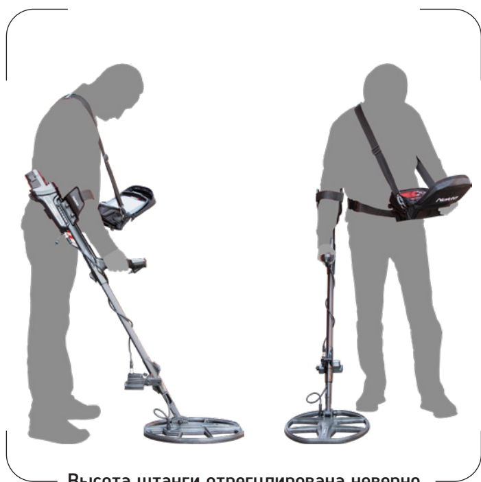
Высота штанги отрегулирована неверно
