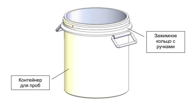
Внешний корпус ОП-прибора изготовлен из анодированного алюминиевого литья. Контейнер для проб и верхняя часть герметично стягиваются между собой с помощью быстроразъемных соединений. Заполнение водой и удаление воздуха выполняется с помощью двух шаровых кранов.
