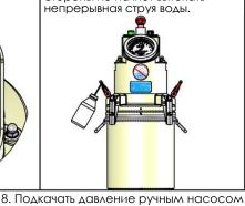
6. При постоянной подаче воды прибор следует наклонить и перемещать круговыми движениями до тех пор, пока из правого шарового крана не перестанут выходить пузырьки воздуха.
