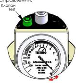
10. Шланг с резьбовым соединением закрепить на левом шаровом кране. Направить шланг в соответствующий мерный цилиндр и открыть шаровой кран. Нажатием клапана Test и подкачиванием насосом отобрать 100 г, 250 г или 400 г воды. Закрыть левый шаровой кран
