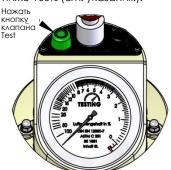
5. При открытых шаровых кранах заполняйте воду с помощью шланга или бутылки-распылителя до тех пор, пока с другой стороны не начнет вытекать
