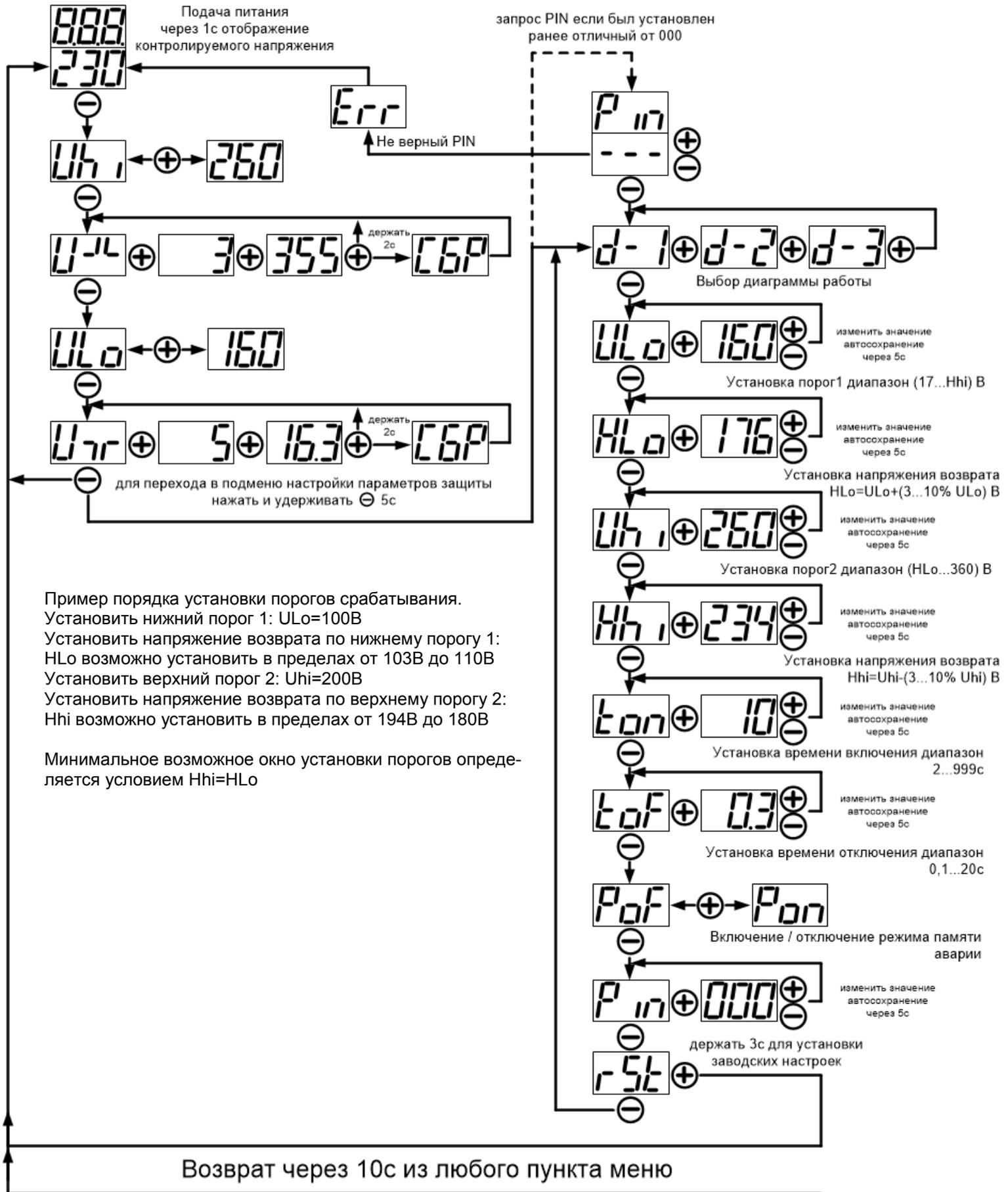
Пример порядка установки порогов срабатывания.
