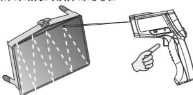
по площади с учётом времени измерения (примерно 2 измерения в секунду). Во время измерения прибор на основном поле дисплея будет отображать текущую температуру, а в дополнительном поле максимальную или минимальную зафиксированную температуру. После окончания измерения отпустите курок, измеренные значения зафиксируются – режим «HOLD». При следующем нажатии курка начнётся новое измерение – предыдущие измеренные значения сбрасываются.
