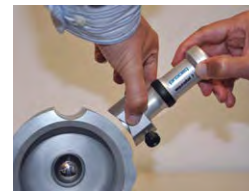
Рисунок 18: Специальное опорное кольцо Portable Rockwell
