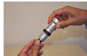
Рисунок 17: Equotip Portable Rockwell с трехточечным опорным кольцом
