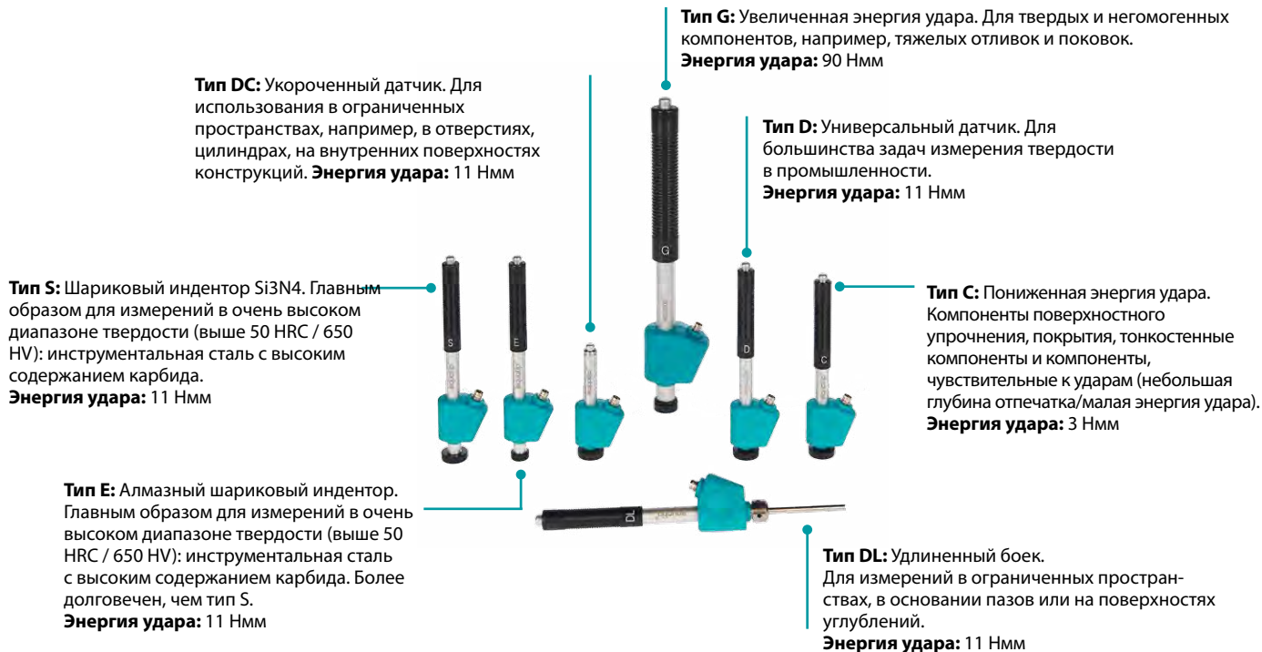
Рисунок 13: Датчики Equotip Leeb
