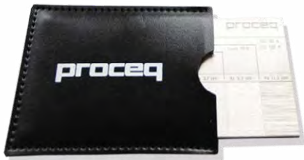
Рисунок 12: Сравнительная пластина для определения шероховатости поверхности
