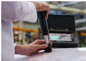
Рисунок 7: Процедура измерения Leeb U
