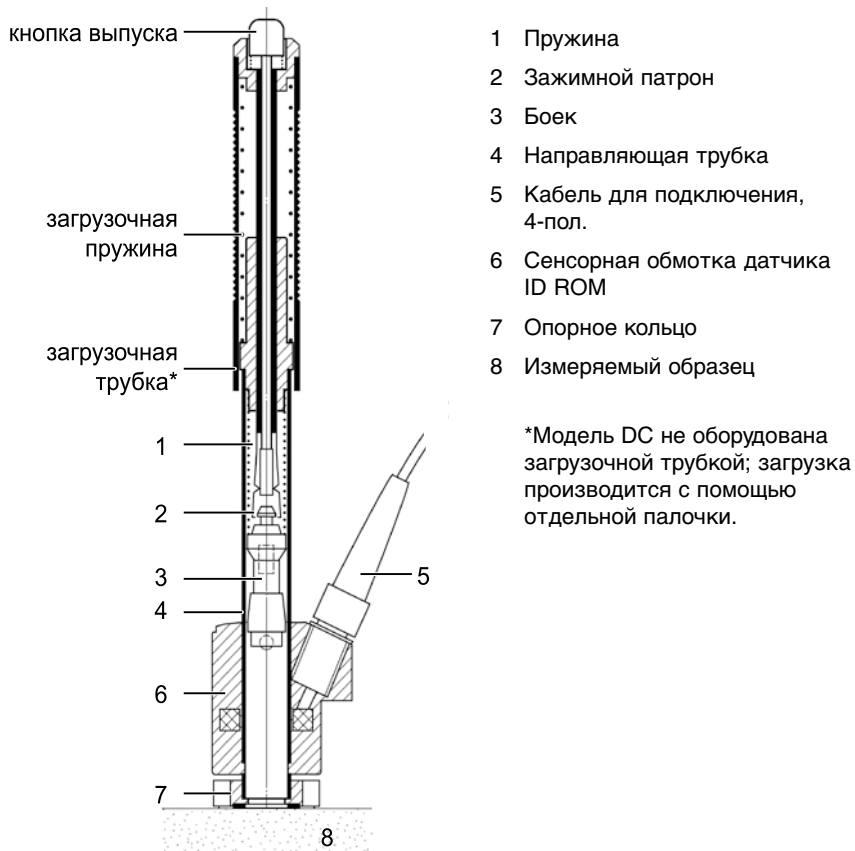
Рис. 2.02 Разрез датчика
