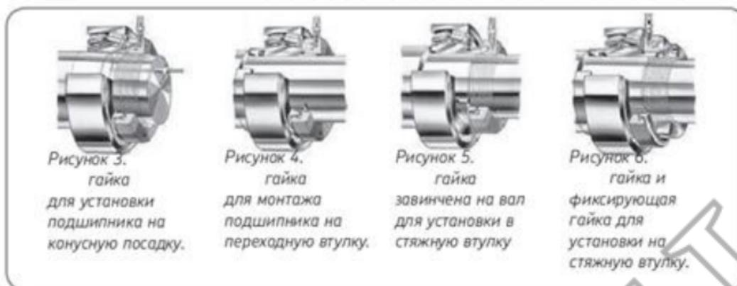
После того, как монтаж завершен, возвратный клапан насоса необходимо открыть, чтобы закачанное масло вытекло из гайки. Для опустошения гайки поршень необходимо вернуть в исходное положение. Навинчивайте гайку дальше по резьбе вала или втулки до возвращения поршня в исходное положение. В этом случае масло вернется в насос.
