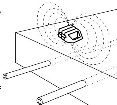
2. На кабель под Genny4 уже не должен поступать поисковый сигнал, а на другие кабели поблизости должен передаваться сигнал Genny, что позволяет обнаружить их с помощью С.А.T4.
