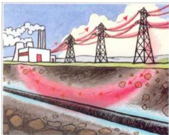
2 Приемник локализует два типа "Пассивных" сигналов. Мы называем их "пассивными", так как они уже существуют на заглубленных трубах и кабелях, что и позволяет нам их детектировать.
