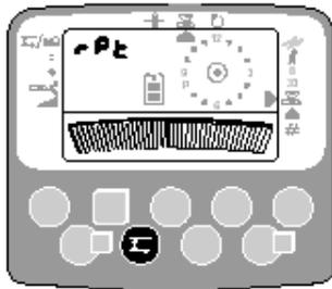
Положите зонд на землю на расстояние 1 м, 2 м, 3 м и т.д. от приемника и каждый раз производите замер глубины.
