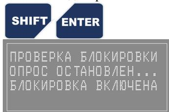
Во время срабатывания блокировки в «режиме проверки блокировки» отключается опрос всех устройств;
