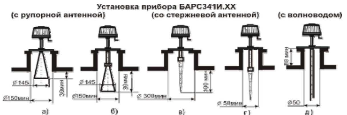
Рисунок 3 - Правила установки прибора
