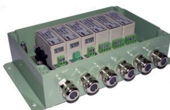
Рисунок 5 - Многоканальное устройство сопряжения УСО ПИК-V (VT) Внешний вид одноканального устройства сопряжения УСО ПИК-T-1 приведен на рисунке 6.
