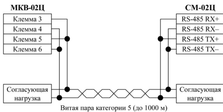
**Рис. А.3.** Схема подключения Модуля MKB-02Ц к Модулям «СМ-02Ц»
