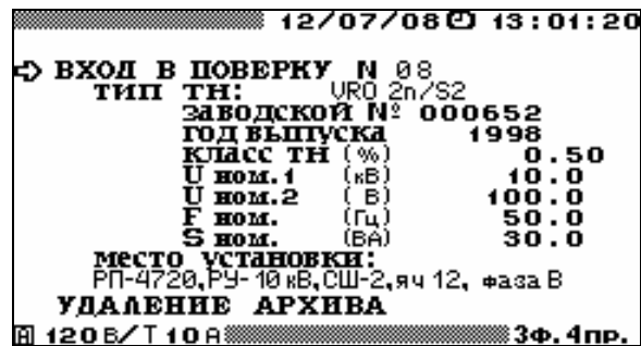
Рисунок 4.6.2 Окно параметров поверки трансформаторов напряжения
