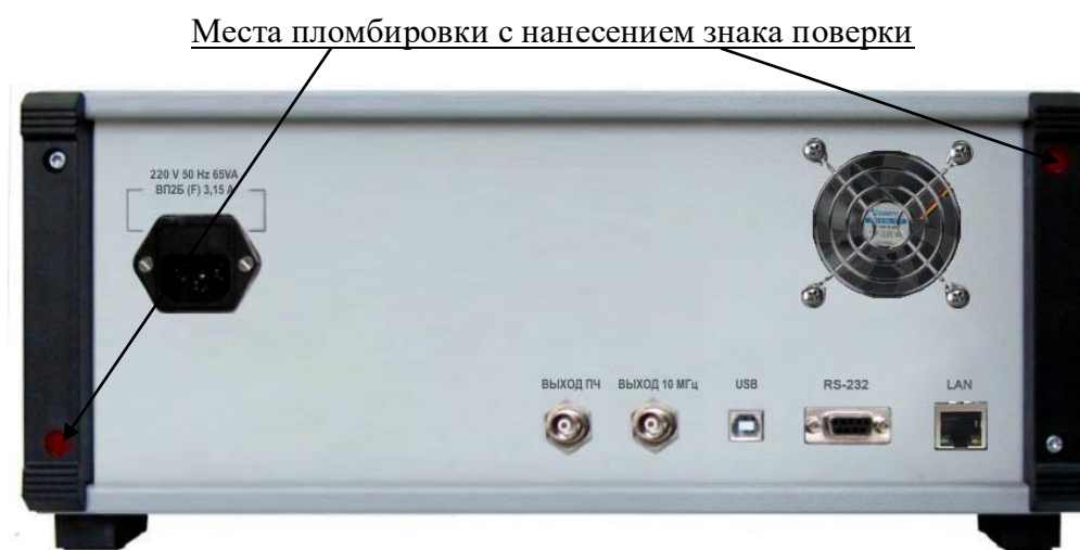
Рисунок 2 – Схема пломбировки от несанкционированного доступа, обозначение мест нанесения знака поверки
