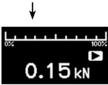
Предварительная нагрузка. Поверните колесико для создания ненапряженного состояния испытательного диска. Прикладываемое усилие отображается в виде мигающего значения. Обычно подходящее усилие составляет 0,1 кН (22 фут-силы). Нажмите центральную клавишу для начала измерения.
