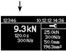
После завершения измерения на экране отображается пиковая нагрузка, продолжительность испытания и фактический уровень нагрузки. Двигатель автоматически отводится в исходное положение и готов к началу следующего измерения.
