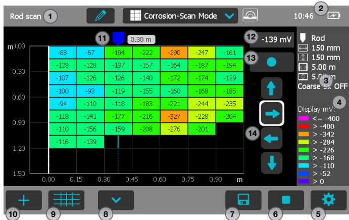
Рисунок 36: Режим сканирования коррозии со стержневым электродом
