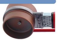
достигнет рабочей температуры, погаснет индикатор нагрева и загорится зелёный индикатор готовности – можно приступать к сварке. Время нагрева аппарата зависит от температуры и движения воздуха в помещении, где проводится сварка.
