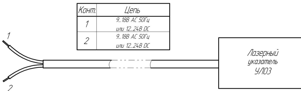
Рисунок 1. Наименование проводов питания (маркировка проводов не производится, цифры 1 и 2 показаны условно, модуль не чувствителен к перемене полярности).
