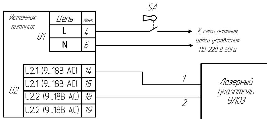
Рисунок 4. Схема подключения лазерного указателя к цепям 110-220В 50 Гц с внешним источником питания.
