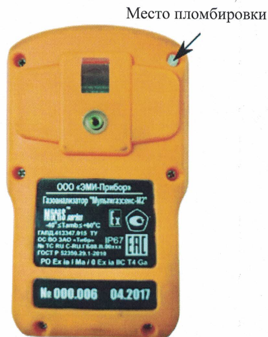
Рисунок 2 – Схема пломбировки от несанкционированного доступа МУЛЬТИГАЗСЕНС-М2
